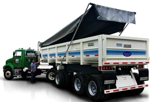
Figura 102. Ejemplo de camión con protección en la tolva para evitar emisiones de material particulado a la atmósfera.
