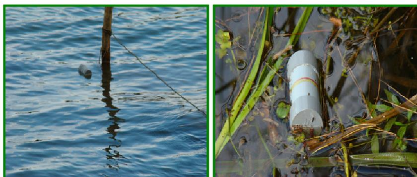
**Figura 15.** Cápsulas plásticas conteniendo sensores para mediciones de temperatura del agua.
