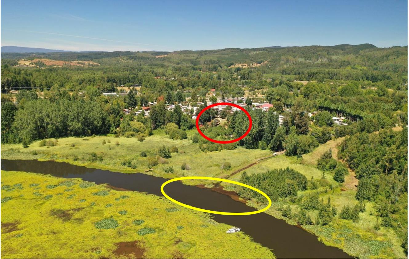
**Figura 25.** Zona de ubicación de la PTAS (elipse roja) de Villa Cayumapu y ribera donde aparentemente se descargan los efluentes de la misma (elipse amarilla).
