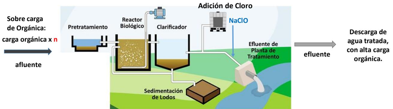
**Figura 33.** Esquema de una PTAS operando en desequilibrio operacional, debido a sobre carga de materia orgánica.
