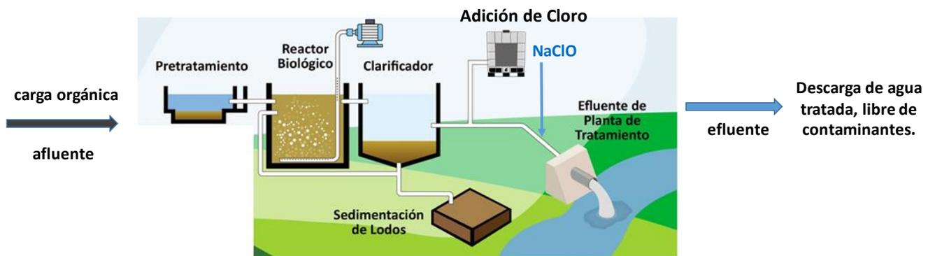
**Figura 32.** Esquema de una PTAS operando acorde parámetros de diseño.
